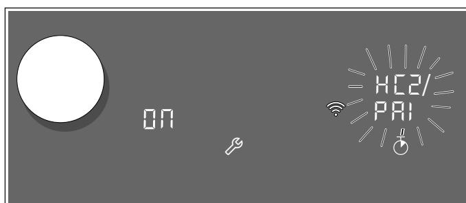
Прибор пытается автоматически установить соединение с приложением. В зоне настройки поочерёдно мигает индикация и . На индикаторе конфорки мигает значение .
