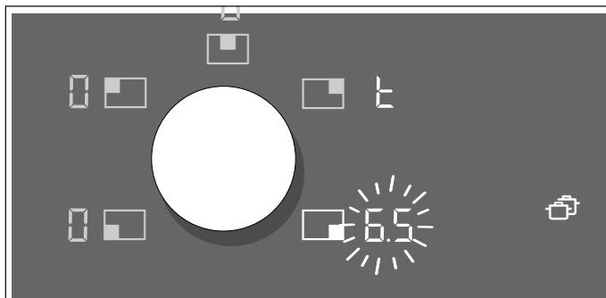
**3** В течение 90 секунд выберите новую конфорку магнитным переключателем. Установка принята.
