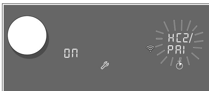
Прибор пытается автоматически установить соединение с приложением. В зоне настройки поочерёдно мигает индикация **HC2** и **PR1**. На индикаторе конфорки мигает значение **ON**.
